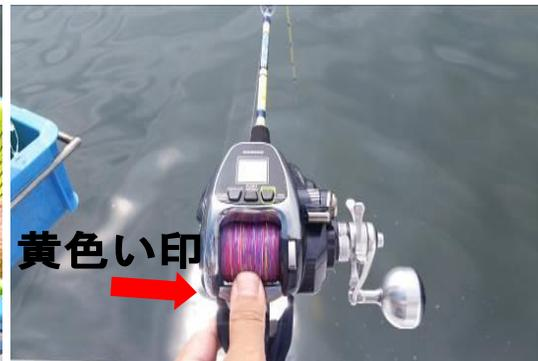
⑥電動リールの黄色い印を押し、糸を出します。液晶画面の数字が指定水深まで到達したら親指で抑え、糸が出るのを止め、ハンドルを回し、カチッと音がなったら OK です。
